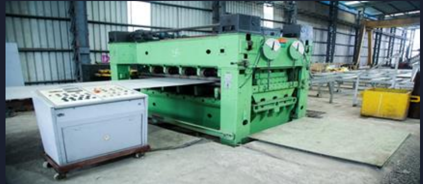
Clad Sheet Leveler
